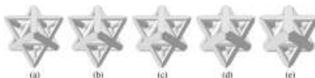
Fig. 1. 부피분율에 따른 Octet-truss 구조의 형상 변화: (a)Cu 23vol%; (b)Cu 26vol%; (c)Cu 30vol%; (d)Cu 38vol%; (e)Cu 45vol%
